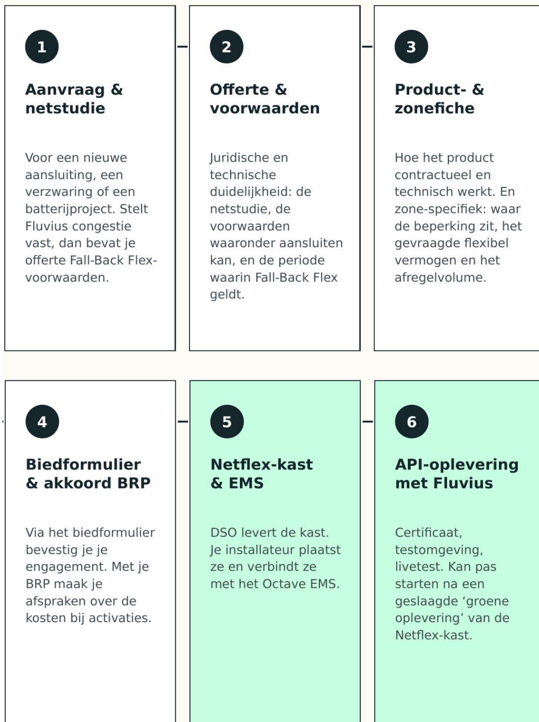
FIGUUR 3 – VAN NETSTUDIE TOT EEN AANSLUITING DIE LIVE GAAT. STAP 5 EN 6 ZIJN HET DEEL WAAR DE INSTALLATEUR EN HET OCTAVE EMS SAMENKOMEN.
